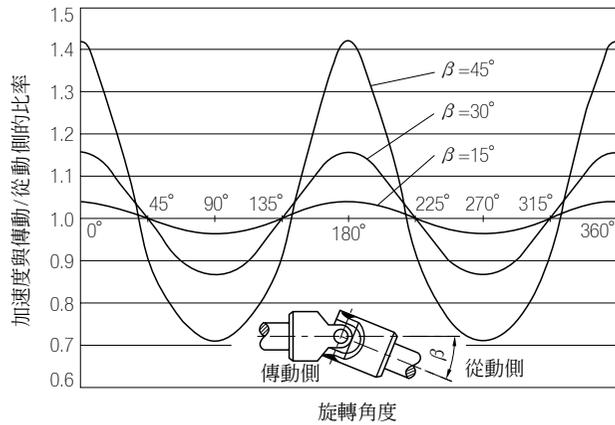
為了實現轉速的平穩傳遞,傾斜角  $\beta$  必須等於連接軸的螺柱端
